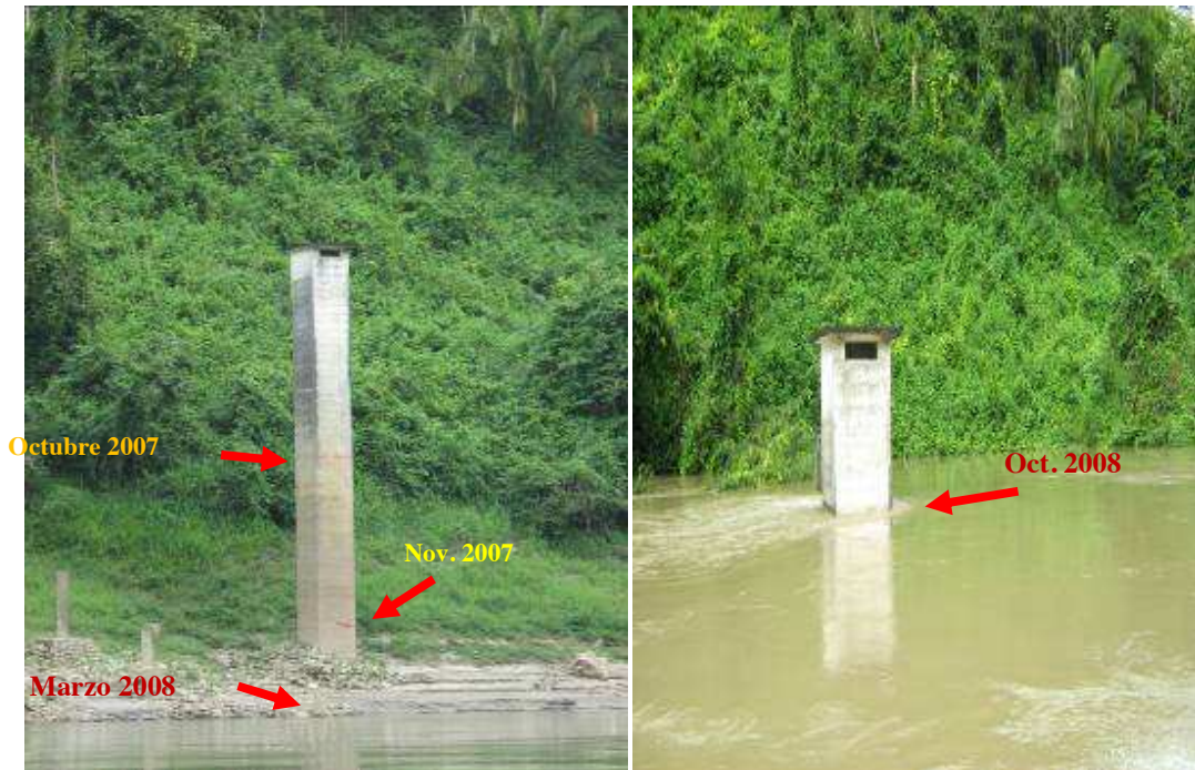
Fotografía No. 54 Comparación del nivel del agua en la torre de control Yaxchilán, Río Usumacinta, La Libertad, Petén en la época seca (fotografía de la izquierda) y la época lluviosa (fotografía de la derecha)
